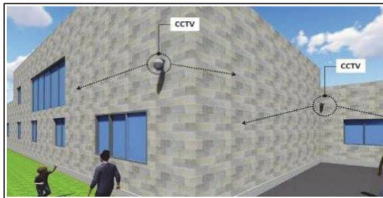
[그림 IV-4] 건물 모서리 및 사각지대 CCTV 설치 및 행동인식 AI 프로그램 사용
