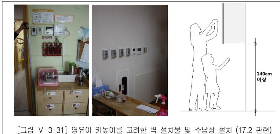
[그림 V-3-31] 영유아 키높이를 고려한 벽 설치물 및 수납장 설치 (17.2 관련)
