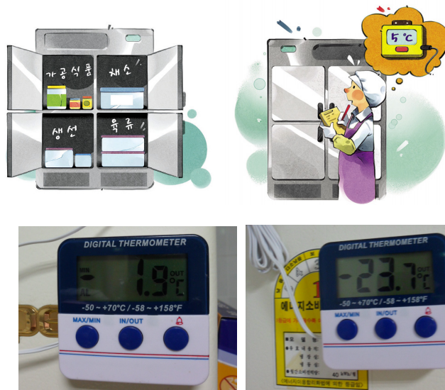
그림 2-7. 내부 온도표시가 되지 않는 경우 외부 부착형 온도계를 설치하여 냉장·냉동고의 온도를 관리하는 예시자료
